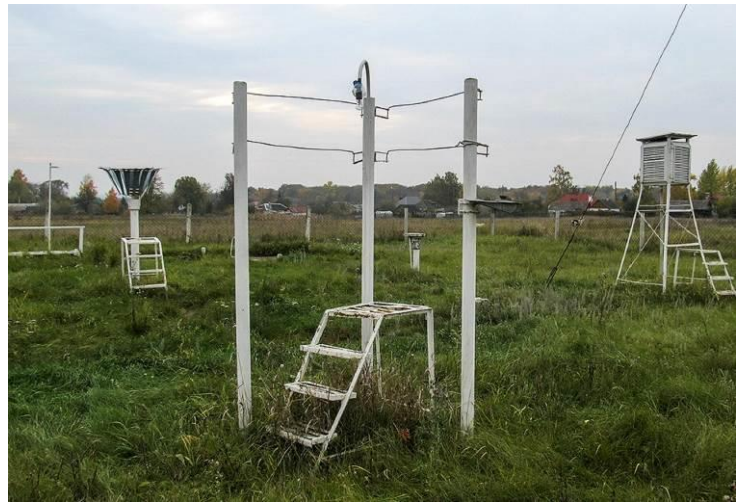
Рис. 5.7 Ожеледний станок на метеорологічному майданчику
