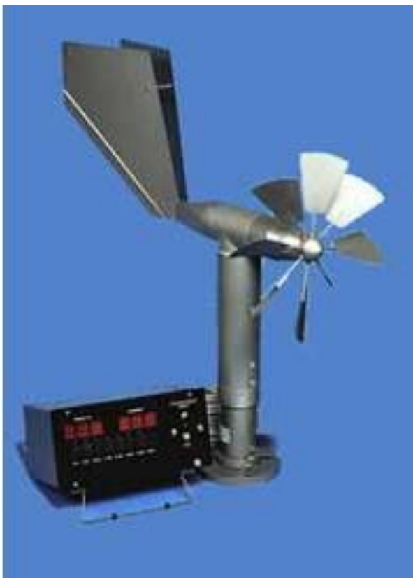
Рис. 5.4 Анеморумбомір та флюгер Вільда
